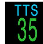
Die Aufstiegszeit in Minuten. Dies ist die aktuelle Dauer, einschließlich aller erforderlichen Dekompressionsstopps, um an die Oberfläche zu gelangen.
