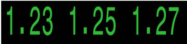
Im CC/BO-Modus mit drei Sensoren und externer PO<sub>2</sub>-Überwachung zeigen alle Positionen der mittleren Zeile PO<sub>2</sub>-Informationen an.
