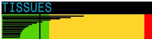
Der Gewebebalken zeigt die Inertgas-Gewebespannung des Gewebekompartiments nach dem ZHL-16C-Modell von Bühlmann an.
