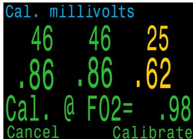
Wenn Sie die Kalibrierung des Gas-FO<sub>2</sub> ändern müssen, können Sie dies im Menü „System Setup“ unter „O2 Einstellungen“ tun.
