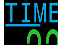
Die Sekundenanzeige ist ein Balken, der unterhalb des Wortes „Zeit“ verläuft. Es dauert 15 Sekunden, um einen Buchstaben des Wortes zu unterstreichen. Der Sekundenbalken wird während des Tauchens nicht angezeigt.
