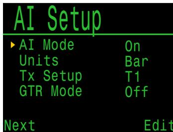
Wenn der **AI Modus** auf **Aus** steht, ist das AI-Teilsystem vollständig ausgeschaltet und verbraucht keinen Strom. Bei aktiviertem AI-System erhöht sich der Stromverbrauch um etwa 10 %.
