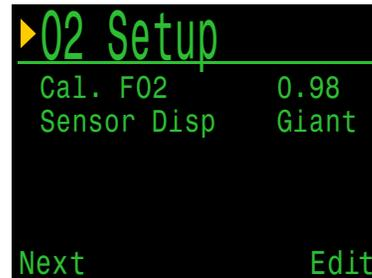
Im Modus des geschlossenen Kreislaufs (SC) kann der FO<sub>2</sub> des kalibrierten Gases zwischen 0,20 und 1,00 eingestellt werden. Grund dafür ist, dass Taucher bei einem halb geschlossenem Kreislauf nicht immer reinen Sauerstoff zur Verfügung haben.
