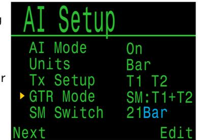
VAGZ und LVO basierend nur auf einer Flasche oder zwei Flaschen bei einer Sidemount-Konfiguration. Beachten Sie, dass die Flaschen der Sidemount-Konfiguration gleich groß sein müssen, damit der LVO korrekt ist.
