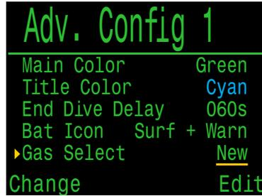
Stellen Sie unter „Adv. Setup 1“ die Option „Gasauswahl“ auf „Neu“, um den neuen Stil des Menüs „Gas definieren“ zu verwenden.
