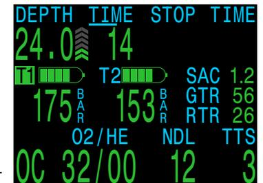
Die Einstellung der Wechselmeldung ist im Bereich von 7 bis 69 bar oder 100 bis 999 psi möglich.
