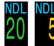
Die verbleibende Zeit in Minuten in der aktuellen Tiefe, bis Dekompressionsstopps erforderlich werden. Wird **gelb** angezeigt, wenn die NZ kleiner als der untere Nullzeitgrenzwert (standardmäßig 5 Minuten) ist.
